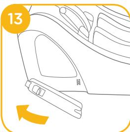
4. Setzen Sie die Verbindungsstücke ISOFIX in Reihe mit den ISOFIX Schienen und danach befestigen Sie die beiden Verbindungsstücke ISOFIX in den Befestigungspunkten ISOFIX. 14
